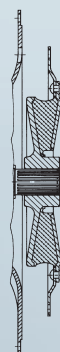
Встроенные опоры вала с высокоэластичной муфтой VULKARDAN E Integral Shaft Support with a highly flexible VULKARDAN E coupling
